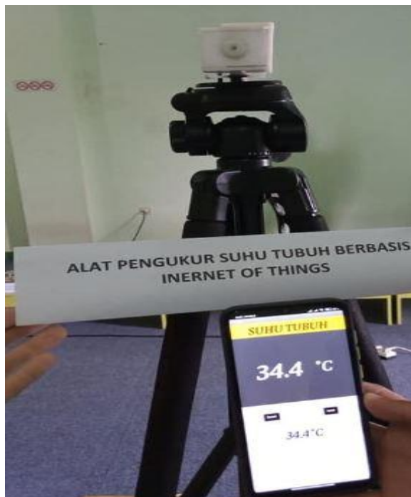
Gambar 7. Hasil akhir alat pengukur suhu tubuh
